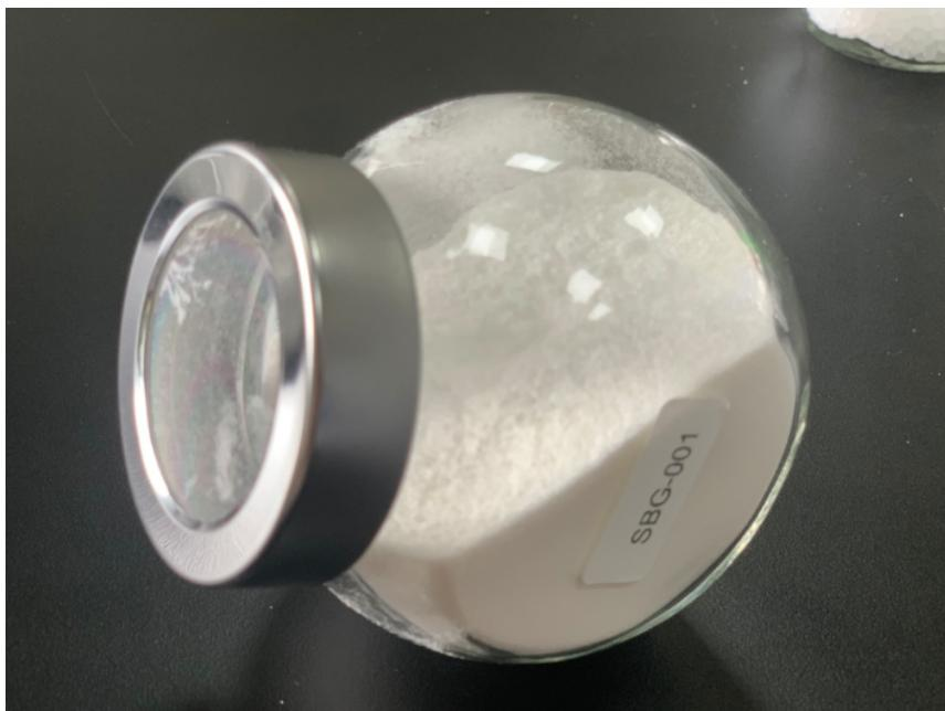
橡胶增韧剂的主要用途：橡胶增韧剂具有塑料和橡胶的双重性能，与其它塑料和橡胶有良好的相容性，因而除少数用作主体材料外，橡胶增韧剂与多数橡胶或塑料并用。塑料作为结构材料的一种，强度和韧性是两个重要的力学性能指标，因此塑料的增韧改性一直是塑料改性的一大方向，现今通过添加增韧剂仍是材料增韧较直接有效的手段。不同增韧剂应用范围不尽相同，常规的添加量也有所差异，例如PP-g-MAH（马来酸酐接枝聚丙烯）比较适用于PA/PP、PA/PE共混合金中，还可起到相容剂的作用，添加量一般约为5%左右。合金改性增韧剂增韧剂一般需要多少钱？
