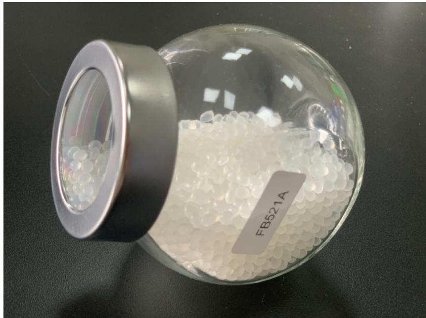
增韧剂的选用：1、根据环氧体系需要选用增韧剂。需要提高抗冲击强度的体系，海岛结构类、长链分子类、胺醚类、橡胶弹性体均可选用。需要提高伸长率体系，两个以上官能团的长链分子类、橡胶弹性体均可选用。需要对耐热影响幅度小的增韧体系，需选用“海岛结构”类或多官能团分子带芳环或脂环结构的增韧剂。2、注意增韧剂的官能团，两个或两个以上活性官能团的分子，交联密度高，对耐热或机械强度影响相对较小。官能团如消耗羟基，固化物的界面粘接强度大幅下降。欢迎致电上海佳易容咨询增韧剂。合金改性增韧剂
